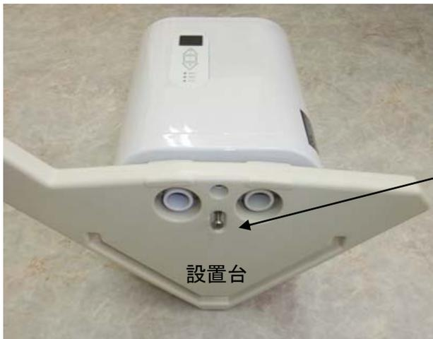
1.本体から各ホースを抜き、固定ネジをプラスドライバーで外してください。設置台が浴槽に固定されている場合は、設置台を外さず、作業を行ってください。
